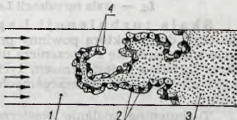
Rys. 6.29. Mikroobjętościowy model spalania turbulentnego: 1 — świeża mieszanka palna, 2 — reakcję zachodzące w danej chwili w mikro-wirach, 3 — spaliny, 4 — mikro-wiry, w których w danej chwili nie zachodzi reakcja
