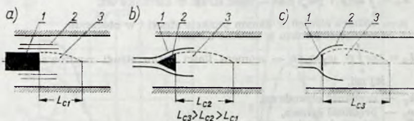
Rys. 3.17. Zależność długości strefy cyrkulacji od kształtu przedniej części ciała nieopływowego (statecznika płomienia) a — walec, b) stożek, c) płaska płytki: 1 — ciało nieopływowe, 2 — linie prądu, 3 — strefa cyrkulacji, L_c — długość strefy cyrkulacji
