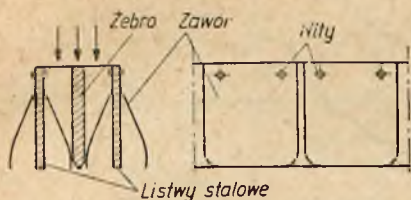
Rys. 7.9. Zawory sprężynowe
