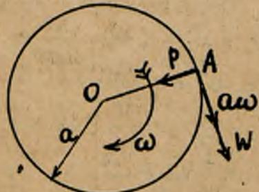
Zad. 63. W chwili t przyspieszenie względne  $q_2 = p$ ;  $OM = r = \frac{p}{2} \cdot t^2$ . Przysp. mnożenia  $p_2 = r\omega^2 = \frac{pt^2\omega^2}{2}$ ; posiada kierunek odwrotny (składowa styczna = 0, bo  $\frac{d\varphi}{dt} = 0$ ).
