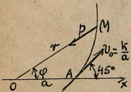
$\frac{d\varphi}{dt} = \frac{C}{r^2}$ . Wyznaczamy stałą C:
