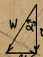
Zad. 16. Rozważamy ruch częstek wody względem idącego. Pionowa szybkość bezwzględna  $v$  jest wypadkową poziomej urośnienia  $u$  i względnej  $w$ , zatem laska paruła powinna być nachylona ku przodowi pod kątem do pionu  $= \arctan \frac{u}{v}$ .
