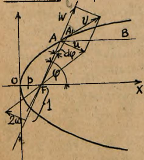
2<sup>nd</sup> sposób. Po czasie dt prosta obraci się o kąt  $d\varphi = 2w dt$ . Punkt
