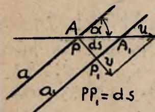
$\text{zaś szybkość szukana } u = \frac{dx}{dt} = \frac{ds}{\sin \alpha \cdot dt} = \frac{v}{\sin \alpha}$ .
