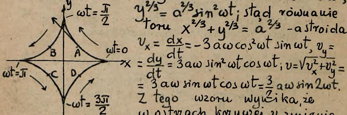
w ostrych kątach kierunek  $v$  zmienia znak. Pochodzi to stąd, że element ds zmiania w tych punktach kierunek, zaś  $v = \frac{ds}{dt}$ . Jeśli chodzi o wartość bezwzgl.  $v$ , to osiąga maximum w punktach A, B, C, D, w których  $\sin 2\omega t = 1, -1, 1, -1$ ;  $2\omega t = \frac{\pi}{2}, \frac{3\pi}{2}, \frac{5\pi}{2}, \frac{7\pi}{2}$ ;  $\omega t = \frac{\pi}{4}, \frac{3\pi}{4}, \frac{5\pi}{4}, \frac{7\pi}{4}$ ;  $|x| = |y| = \frac{a}{2\sqrt{2}}$ .
