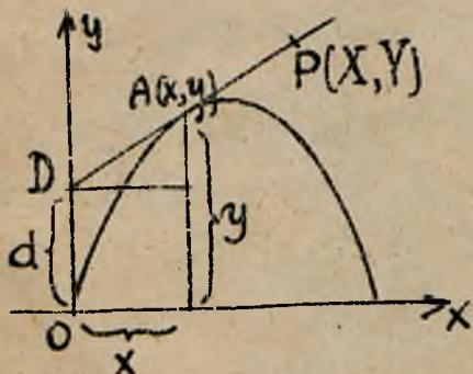
Równanie stycznej z p.  $(0, d)$  jest:  $y - \frac{dy}{dx} \cdot X = d$  lub  $y - \frac{v_y}{v_x} \cdot X = d$ , gdzie  $v_y = v_0 \sin \alpha - gt$ ,  $v_x = v_0 \cos \alpha$ . Chodzi o szarego linię punkt stycznej miażdżenie o punkt zetknięcia z kurwą, zatem  $y = y'$ ,  $X = x$  i
