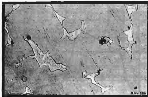
Rys. 13. Stop wyżarzony zawierający 7 0 / 0 atom. cyny. Trawiony odczynnikiem chromowym. Pow. — 150.
