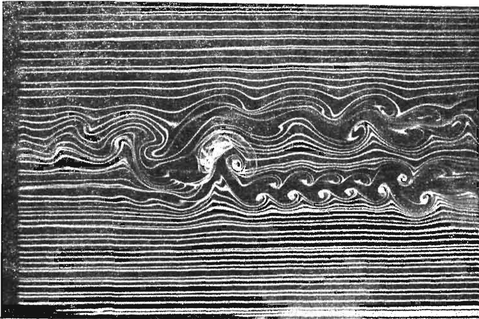
Rys. 6. Chwilowy obraz przepływu z wirum interakcyjnym oraz silnie już zdeformowanym wirum pierwotnym
