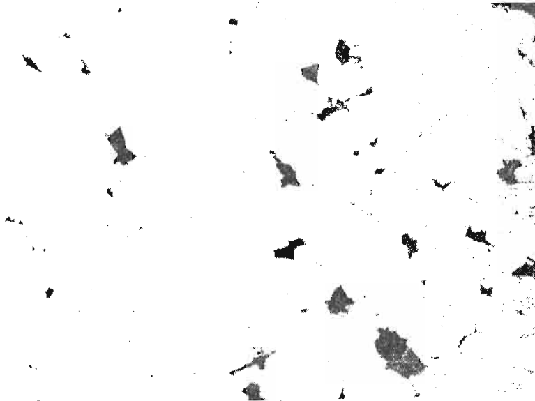
Rys. 3. Pęknięcia typu wnękowego (stal H23N18) — pełzanie w temperaturze 1123 K, naprężenie \sigma = 60 MPa, pow. 50X
