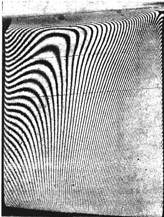
Rys. 5. Powierzchnia łopatki turbiny pokryta prążkami warstwicznymi
