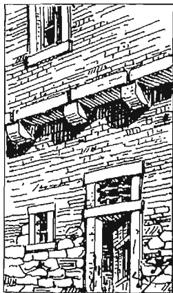
Rys. 51. Nawieszanie ściany piętra w starodawnych budowlach Zachodu. Nr. 1. W budowlach drewnianych na wystających belkach stropu. Nr. 2 i 3. W budowlach murowanych na wspornikach kamiennych z poziomą kamienną beleczką lub arenkami.
