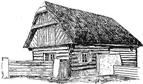
Rys. 44. Chata we Wsiach koło Turnowa w Czechach. Trójkąt szczytowy lekko przed lico ściany wysunięty.
