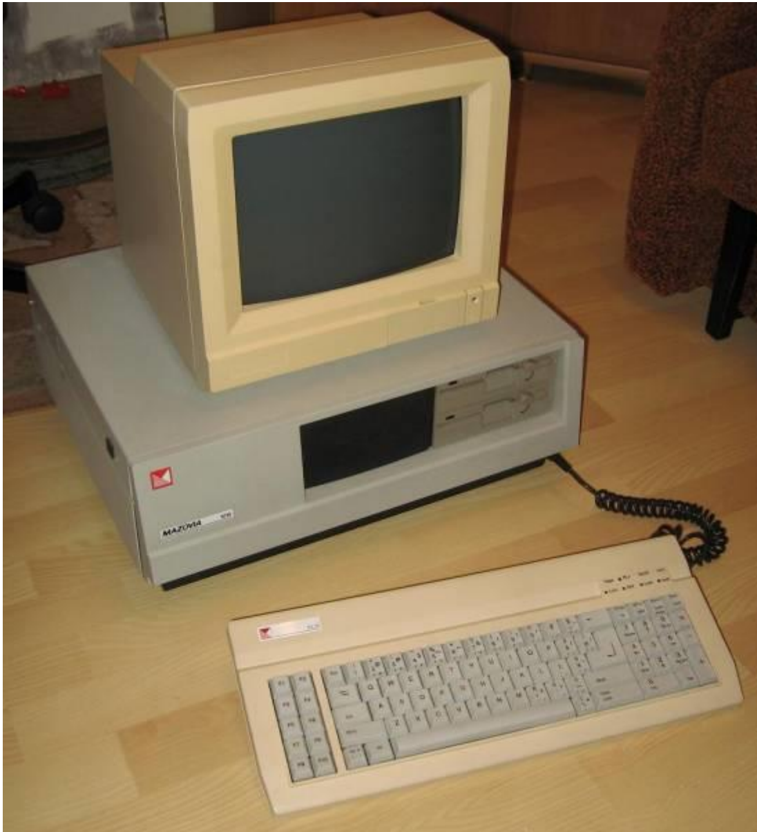
Mikrokomputer Mazovia 1016, polski IBM PC/XT, z podwójną stacją dyskietek 5,25", monitorem MM12P i klawiaturą KL10 (fot. Damian Dudek at pl.wikipedia , na licencji Creative Commons Uznanie autorstwa–na tych samych warunkach 3.0 niezlokalizowana )
