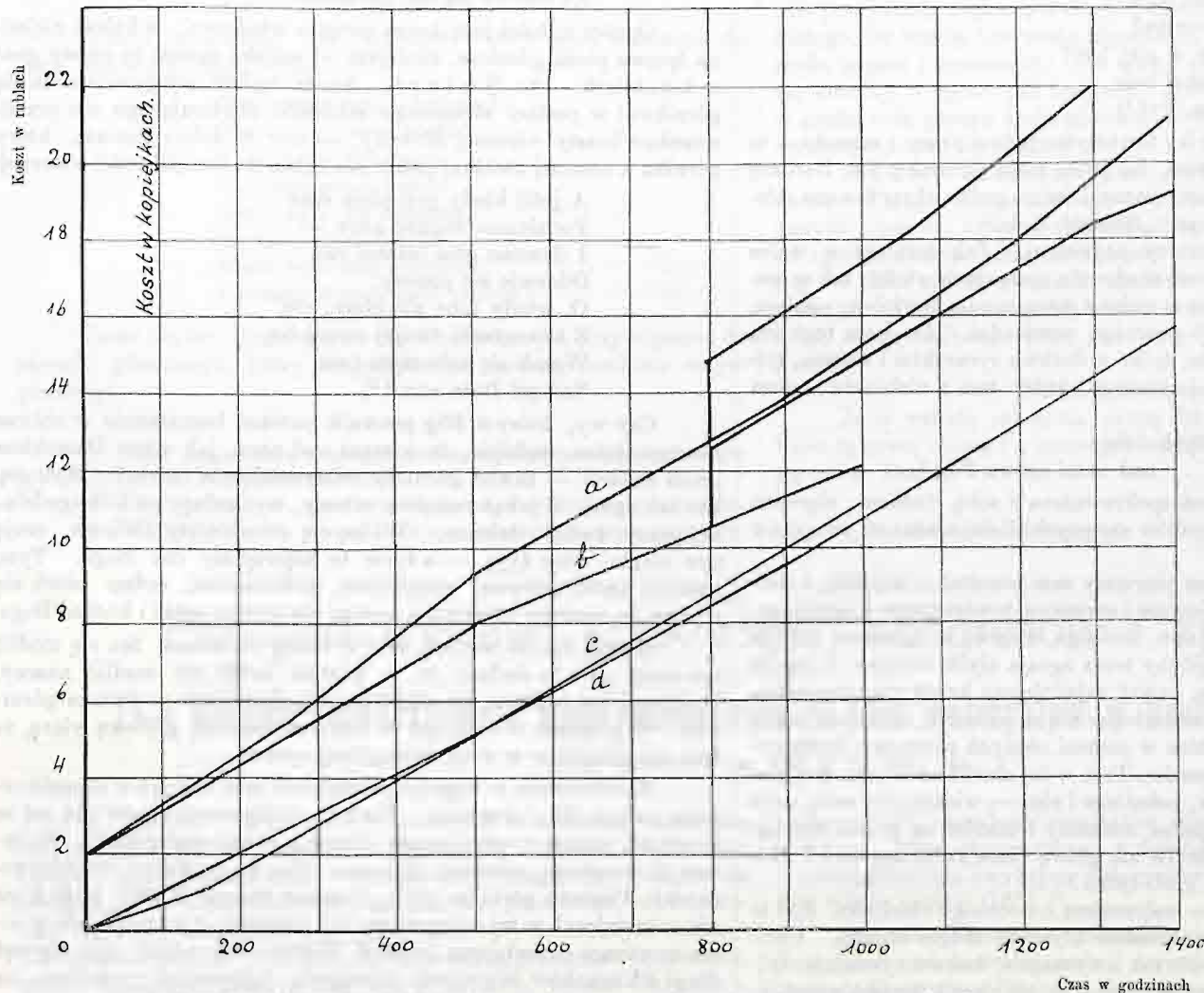
Krzywe a i b: Koszt 25-świecowej lampy w zależności od czasu — w rublach. „ c i d: „ prądu dla jednej świecy „ „ — w kopejkach.
