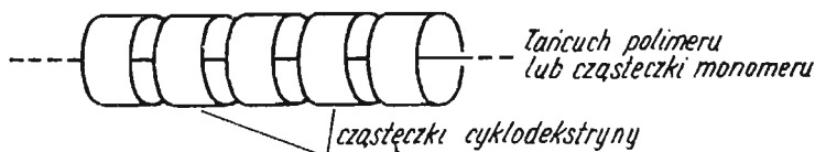
Rys.16. Fragment siatki krystalicznej cyklodekstryny o konstrukcji kanałowej zawierający łańcuch polimeru lub cząsteczki monomeru (schematycznie)
