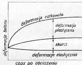
Rys. 2. Przebieg deformacji betonu ściśnionego.
