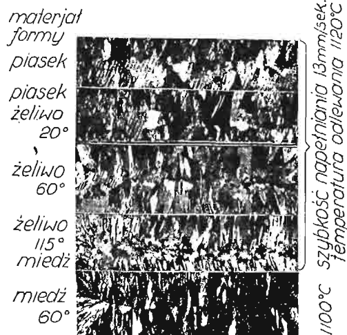
Rys. 8. Wpływ materiału wlewnicy na jakość odlewów.
