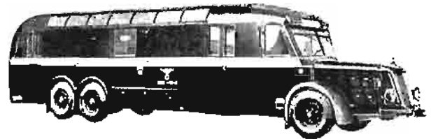
Rys. 10. Wóz 6,5-tonnowy Daimler-Benz , skarosowany dla poczty.
