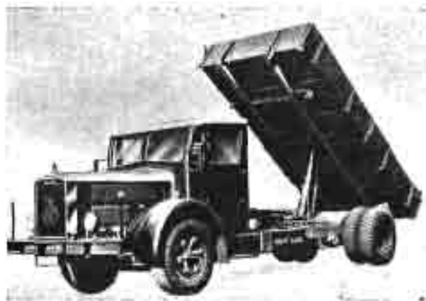
Rys. 12. Podwozie Kruppa 6,5-tonnowe, z przechylną platformą.
