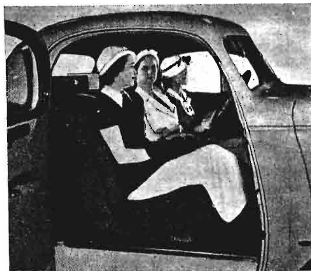
Rys. 2. Zwiększona szerokość i usunięcie lewarków stworzyły miejsce dla trzech osób także na przednim siedzeniu.
