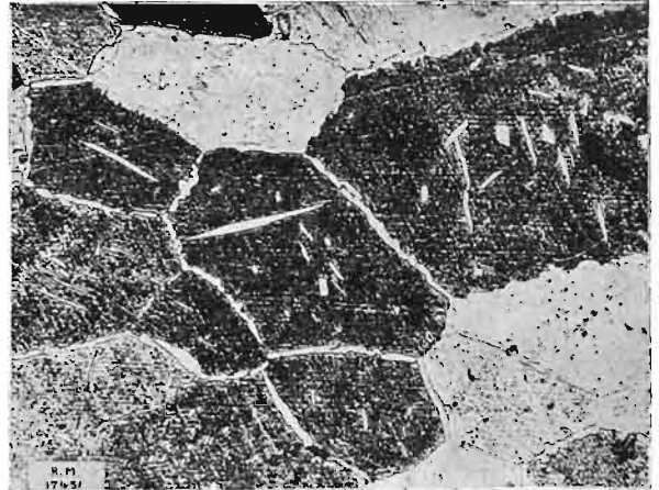
Fig. 12. — Alliage recuit à 44,7 % atom. de zinc. Phase \beta , apparaissant sombre ou claire suivant l'orientation des cristaux dans les cellules, avec résidu de petits cristaux clairs \alpha . Gr.=200.
