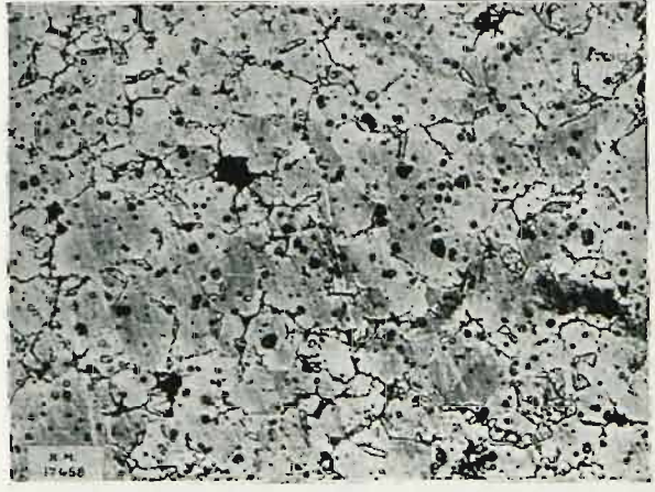
Fig. 19. — Alliage recuit à 68,7 % atom. de zinc. Phase \gamma (claire) et \epsilon (sombre). Gr.=200.
