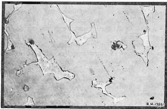
Fig. 13. — Alliage à 7 % atom. d'étain après recuit. Attaque au réactif chromique. Gr=150.
