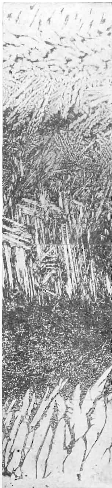
Fig. 11. Filiation des alliages cuivre-aluminium, riches en cuivre, trempée à 1000°. Grosiss. = 200.
