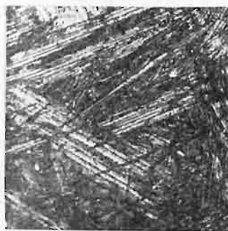
Fig. 12. Composé AlCu_3 trempé à 1000°. Grosiss. = 200.
