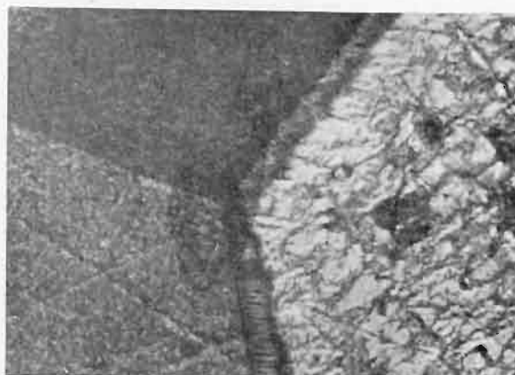
Fig. 13. Alliage à 19,5% d'aluminium. Phase \gamma' en sombre et phase \delta en clair. Grosiss. = 300.
