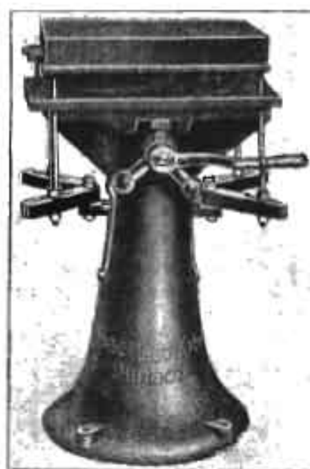
Rys. 1. Typowa formierka z ręcznym ubijaniem i płytą nieobracalną.
