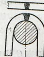
鋼に就て行ふものにして、第七圖に示す如く鋼鋼の中央に於てV形に銲接し、然る後第八圖に示すが如く供試體鋼鋼の厚さの3倍に等しき直径を有する鋼鐵棒の周りに彎曲すべし。
