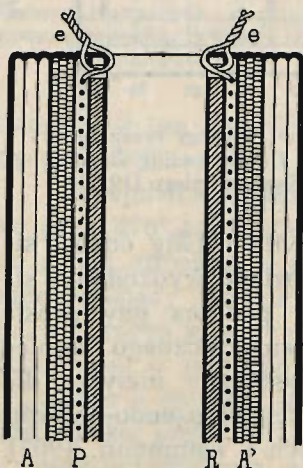
Rys. 84 — Piec elektryczny oporowy. R — rura z glinki ogniotrwałej, na której jest nawinięty drut z nichromu; P — warstwa glinianu wapnia; A i A' — osłona azbestowa; e i e' — elektrody. \frac{1}{3} naturalnej wielkości
