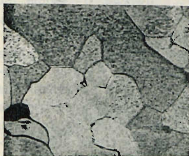
Rys. 21 — Krystaliczna budowa żelaza (Osmond, 1901). Pow. 500X.
