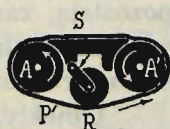
Rys. 24 — Schemat polerki. P — płótno szmirglowe, A i A' — koła pędzące. R — rolka naprężająca. D — stolik.
