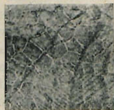
Rys. 2 i 3 — Na lewo : szkło, wytrawione kwasem fluorowodorowym, fotografowane w świetle przepuszczonym. — Na prawo : ołów, wylany na pochyłe szkło; komórki są oddzielone ciemnymi liniami, zaś kryształy — jasnymi. Pow. 300X. (Osmond i Cartaud, 1907).
