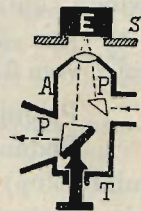
Rys. 9 — Oświetlenie w mikroskopie Le Chateliera. E — próbka; S — stolik; A — obiektyw; p i P — przyzmaty, odbijające całkowicie; T — oś obrotu przyzmatu P.
