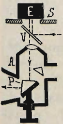
Rys. 12 — Oświetlenie płytka przy słabych powiększeniach. E — próbka; S — stolik; A — obiektyw; V — płytka szklana; P — pryzmat.
