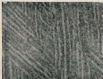
Rys. 162 — Stop, o składzie \text{Al Cu}_3 (Broniewski, 1911). Pow. 500 \times
