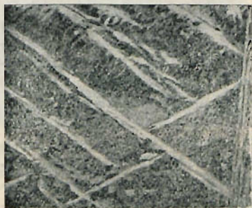
Rys. 153 — Sorbit (ciemny) i cementyt. Pow. = 500. (Osmond, 1901)
