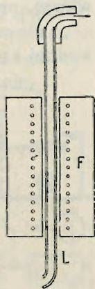
Rys. 125 — Rura ssąca stop (Stepanow, 1912). L — rura kwarcowa połączona z pompą, F — piec elektryczny. \frac{1}{3} naturalnej wielkości
