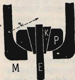
Rys. 205 — Osadzenie probierki prostokątnej. E — probierka; M — szczeka; P — gniazdo; K — kliny; r — promień krzywizny szczeki i gniazda
