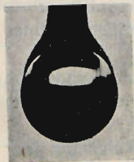
Rys. 198 — Kulka szklana, służąca do pomiarów twardości (Le Grix, 1911)
