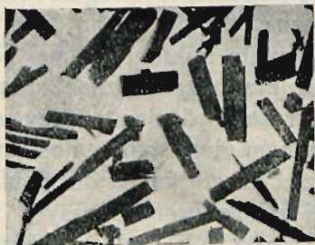
Rys. 33 — Kryształy Mn_3Si wydzielone ze stopu i obserwowane pod zwykłym mikroskopem (Lebeau)
