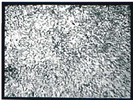
Rys. 128. Stal o 1,5% C bardzo wolno studzona. Na lewo, po wytrawieniu kwasem pikrynowym, widać zaokrąglone jasne kryształy cementytu na tle ferrytu. Na prawo, po wytrawieniu pikratem sodowym, widać ciemne kryształy cementytu na tle ferrytu. P=300 .
