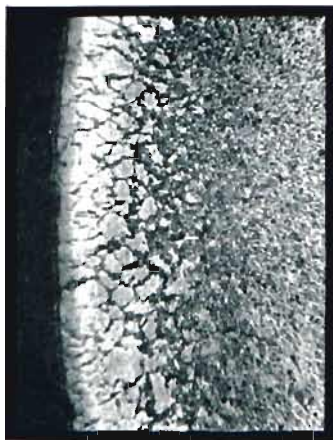
Rys. 123. Drut żelazny powoli cementowany. Widać kolejne warstwy: cementytu na tle perlitu, samego perlitu i drobnoziarnistego ferrytu na tle perlitu. P = 50 .
