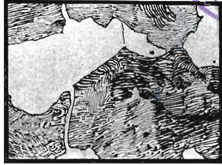
Rys. 26. Stal o 0,4% C. Jasne kryształy ferrytu na tle perlitu. P = 500.
