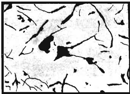
Rys. 19 Surowiec szary nietrawiony. Czarne kryształy grafitu na tle metalu. P = 250 . Na lewo mikrofotografja, na prawo rysunek.
