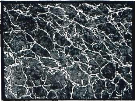
Rys. 27. Stal o 1,5% C trawiona kwasem pikrynowym. Jasne kryształy cementytu na tle perlitu. P = 125.
