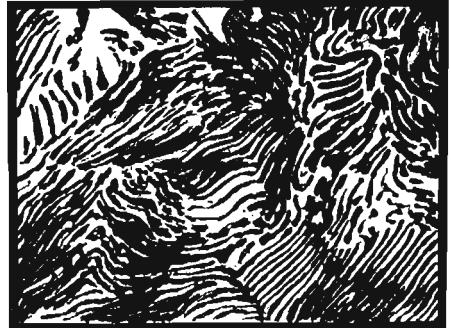
Rys. 54. Stal o 0,8% C po wyżarzeniu. Budowa perlityczna, widać drobną mieszaninę kryształów cementytu i ferrytu. P = 600 . Na lewo mikrofotografia, na prawo rysunek piórkami.
