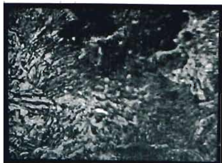
Rys. 88. Poprzednia próbka odpuszczona dłużej lub przy wyższej temperaturze. Sorbit miejscami przechodzący w perlit. P = 1300.
