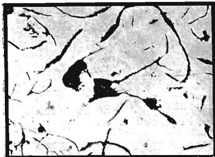
Rys. 19 Surowiec szary nietrawiony. Czarne kryształy grafitu na tle metalu. P = 250 . Na lewo mikrofotografja, na prawo rysunek.
