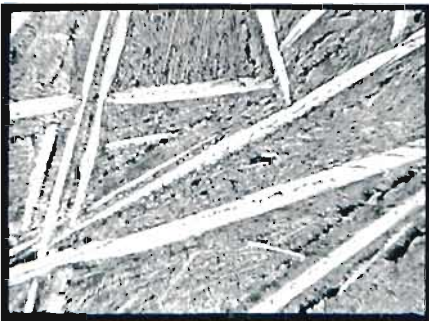
Rys. 10. Surowiec biały nadeutektyczny. Jasne kryształy cementytu na tle ledeburitu. P = 40 . Na lewo mikrofotografia, na prawo rysunek piórkiem.
