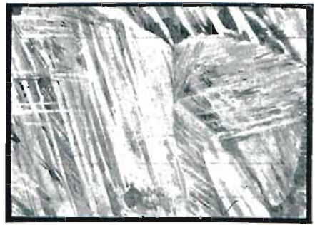
Rys. 50. Poprzednia próbka po zahartowaniu. Kryształy i komórki roztworu stałego. P = 300 . Na lewo mikrofotografja, na prawo rysunek tuszem.
