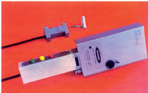
Fotolaryngoskop do badania drgań strun głosowych opracowany w ramach projektu celowego realizowanego wspólnie z Akademią Muzyczna w Warszawie.
