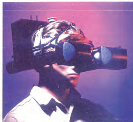
Hełm optyczny („Helmet Mounted Display” HMD) opracowany wspólnie z Swedish Institute of Computer Science – Szwecja.
