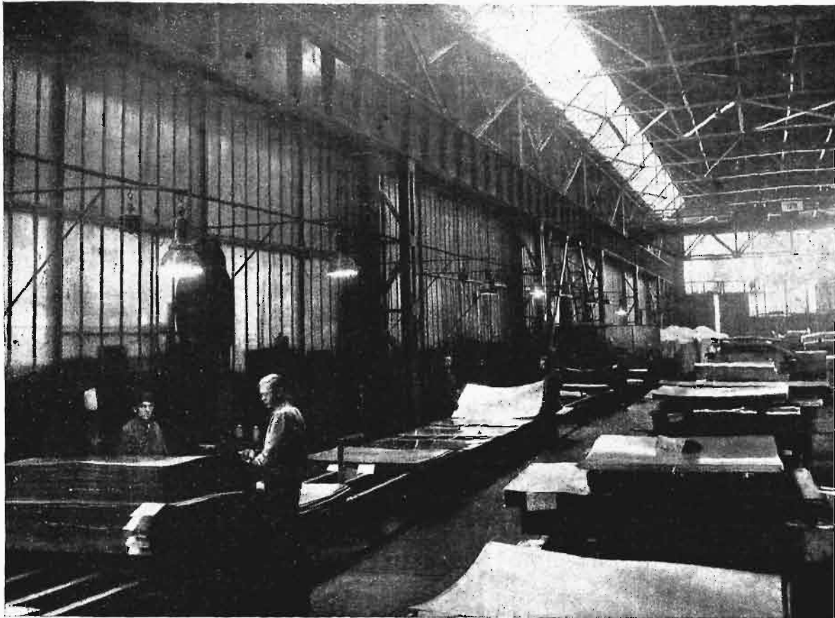
Rys. 2. Walcownia blach, oświetlona lampami rtęciowymi.
