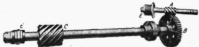
Rys. 106. Napęd stołu ślimakowy (Butler).
