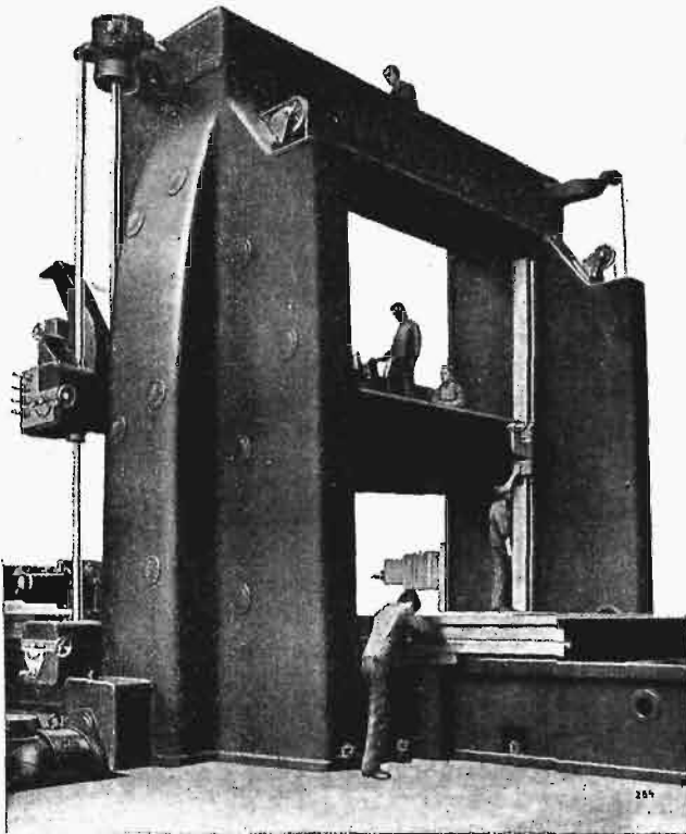
Rys. 113. Sztywna budowa stojaków strugarki (Waldrich) o szerokości stołu 4,5 m.
