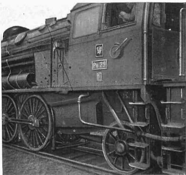
Ustawienie pirometrów rtęciowych na parowozie.
