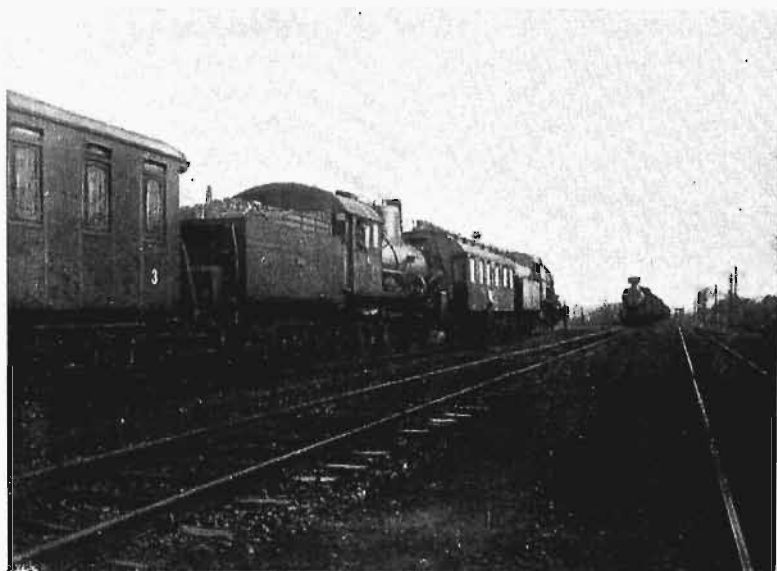
Rok 1926. Pierwszy pociąg doświadczalny pośpieszny na odcinku krakowskim. Parowóz pomocniczy Pf12 za dynamometrem.
