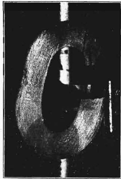
Rys. 31. Linje naprężeń na przekroju ogniwa poddanego próbie na obciążenie. Traw. sposobem Fry'a.
