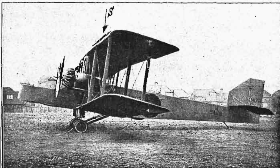
Rys. 2-b. Skrzydło szczelinowe syst. Handley-Page'a (samolot „Hanaidi“ H.-Page'a).
