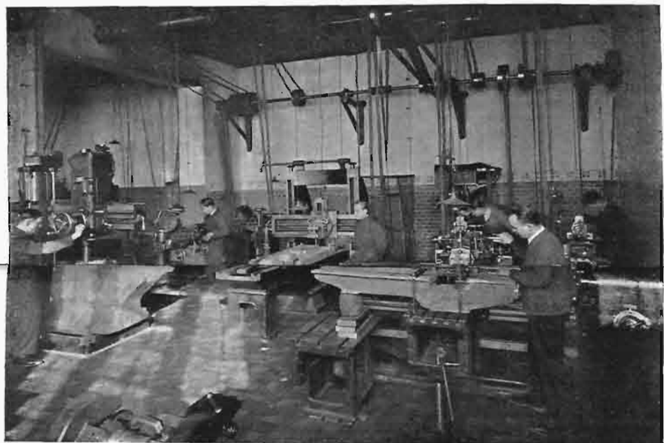
Rys. 10. Sala strugarek i wiertarek. Sala ta jest kolebką warsztatów szkolnych. Na pierwszym planie widać po prawej stronie mocną strugarkę poprzeczną o przesuwowym suwaku roboczym, po lewej — dużą wiertarkę promieniową. W głębi dwie uniwersalne szliwierki narzędziowe.
