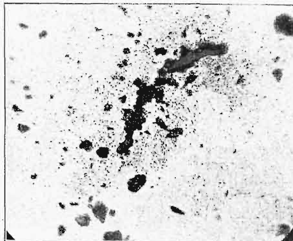
Rys. 4. ( \times 1000 ) Kropla żuźła otoczona troostytem na tle martenzytu.
