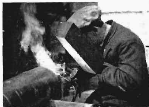
Rys. 2. Nakładanie warstwy na czopie walca.
