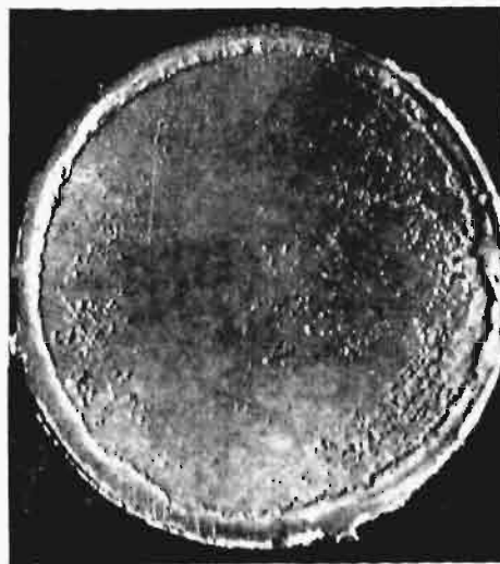
Rys. 5. Korozja na granicy szwu i na powierzchni denka cynkowego.
