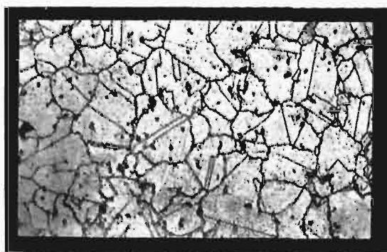
Rys. 7. Stal Nr. 5. Twardość Rockw. C 26. Traw. FeCl 3 . Pow. 450.
