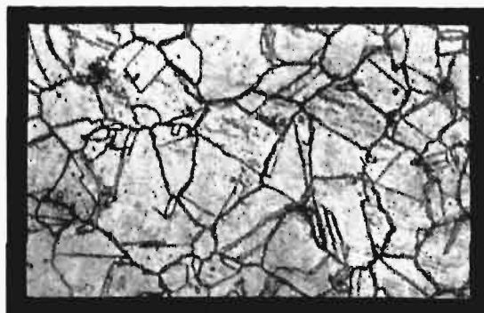
Rys. 9. Próbka z grzybka zaworu ze stali Nr. 3. Pow. 450.
