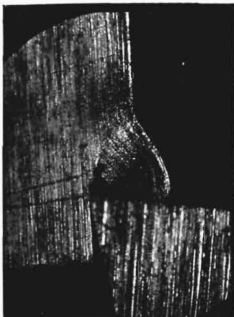
Rys. 10. Zdjęcie mikroskopowe skrawania stali 0,6 — 0,7% C nożem o kątach natarcia 10^\circ i odsadzenia 10^\circ . \times 25 .
