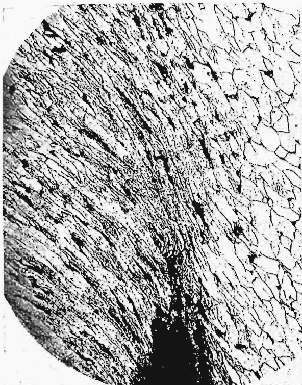
Rys. 22. Zdjęcie mikroskopowe miejsca tworzenia się wióra przy skrawaniu stali b. miękkiej. \times 200 .
