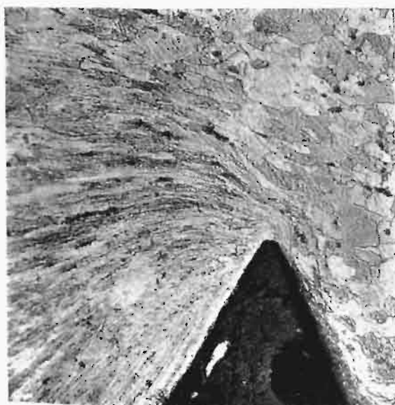
Rys. 33. Zdjęcie mikroskopowe skrawania duraluminu; miejsce przy ostrzu noża. \times 200 .
