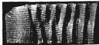
Rys. 23. Fragment wióra duraluminowego przy skrawaniu warstwy o grubości 0,3 mm i szerokości (grubość próbki) 3 mm, powiększenie 8-krotne.
