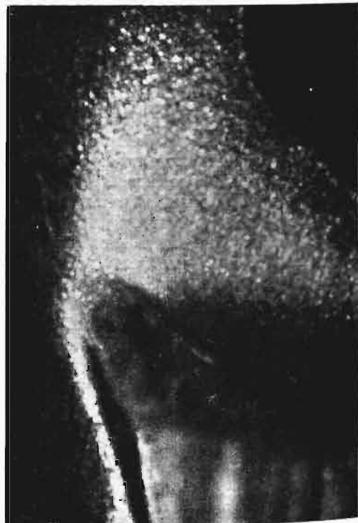
Rys. 14. Tworzenie się klina na ostrzu noża przy skrawaniu stali 0,4% C nożem o kątach natarcia 10^\circ i odsadzenia 10^\circ . \times 25 .
