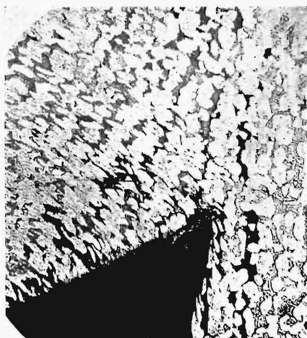
Rys. 37. Zdjęcie mikroskopowe skrawania mosiądzu; miejsce przy ostrzu noża. \times 150 .
