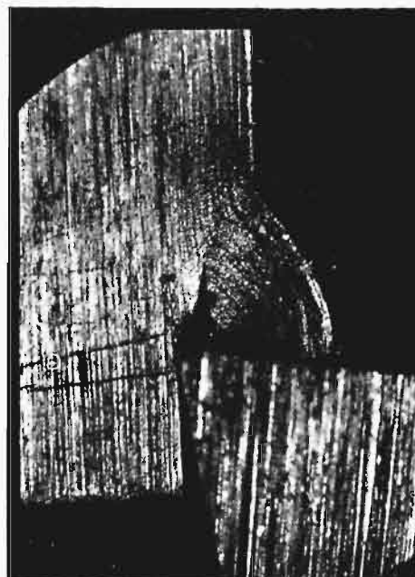
Rys. 11. Zdjęcie mikroskopowe skrawania stali 0,6 — 0,7% C nożem o kątach natarcia 10^\circ i odsadzenia 10^\circ . \times 25 .
