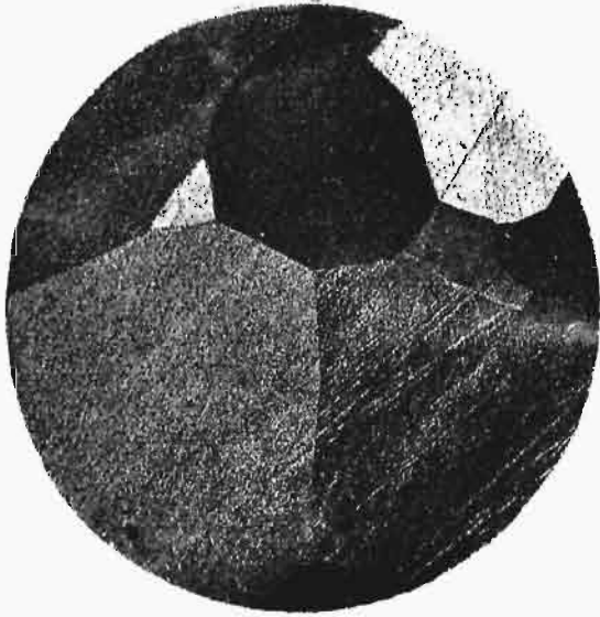
Rys. 15. Mosiądz specjalny (38,26% Zn, 4,06% Mn, 0,9% Al) lany w kokili. Duże kryształy \beta . Pow. 100.
