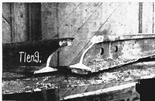
Rys. 5. Złącze z podkładką spawane acetylenem. Przy uderzeniu bijakiem 450 kg z wys. 3 m pękła szyna poza złączeniem.
