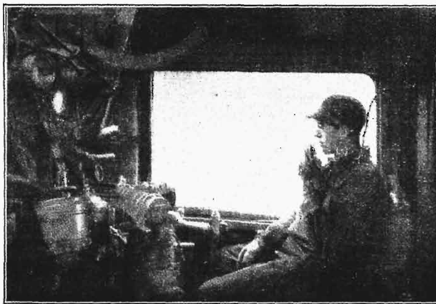
Rys. 1. Widok budki maszynisty z urządzeniem komunikacji radjotelefonicznej na kolei New York Central.
