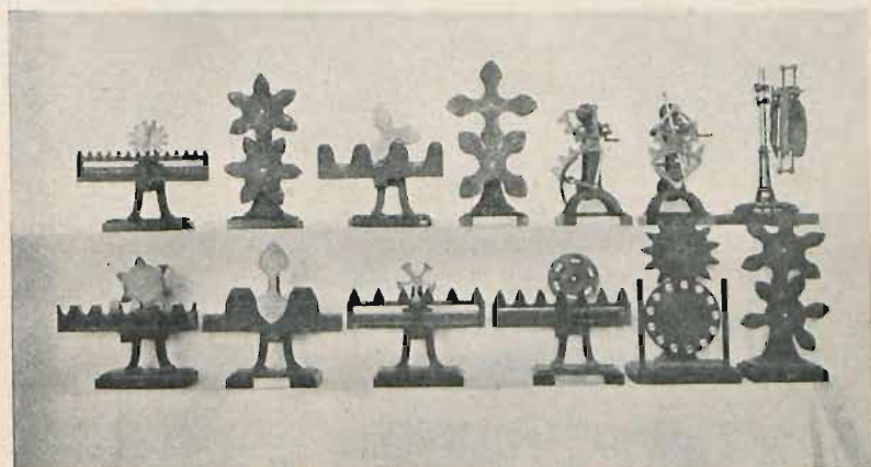
Monachjum — fragment Działu Fizycznego, — modele z kinematyki w/g układu Releaux. Dział ten obejmuje między innymi: eksponaty ilustrujące zasady zachowania energii (np, oryginalny aparat Clausiusa, Helmholtza, Roberta Meyera), aparaty do demonstrowania zjawisk, powstających przy rozrzedzaniu powietrza i wiele innych podobnych eksponatów.
