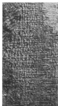
Fig. 1. Ätzdendriten, aus deren Anordnung man die Krystallorientierung ableiten kann. Kupferkristall, geätzt mit Ammoniumpersulfat 1 : 10.
