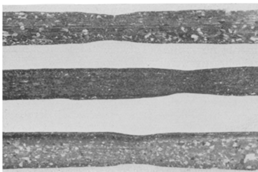
Fig. 44. Drei Aluminiumeinkrystallzerreißstäbe mit Fließkegeln nach der Rekristallisation bei 620^{\circ} . Die Korngröße steht in gesetzmäßigem Zusammenhang mit dem Rekristallisationsschema; sie steht in umgekehrtem Verhältnis zur Festigkeit und Dehnung. Geätzt mit Flußsäure-Salzsäure.
