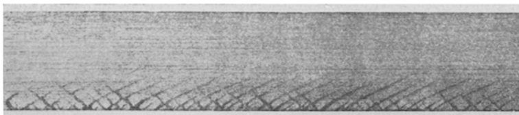
Fig. 40. Unterer Teil des in Fig. 30 dargestellten Aluminiumeinkrystallstabes mit deutlich ausgeprägten Zwillingsstreifen, stärker vergrößert. Geätzt mit Flußsäure-Salzsäure.
