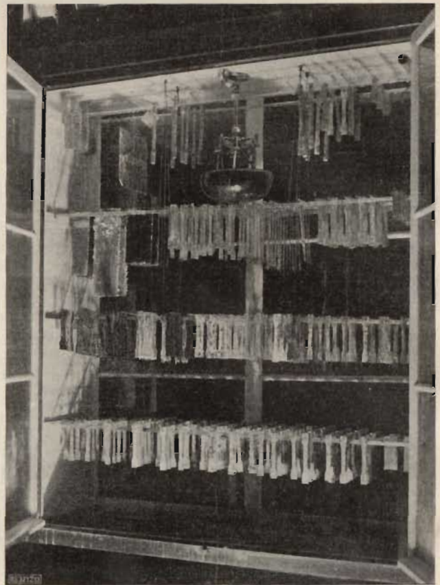
Abb. 13. Korrosions-Sprühkammer
