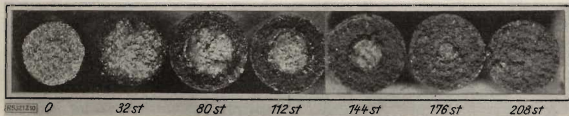
Abb. 10. Bruchaussehen von Messingproben nach verschieden langer Einwirkung von heißer Salzsäure
