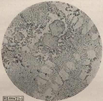
Abb. 3. Al-Si-Legierung unvollkommene Veredelung durch zu gerin- gen Na-Zusatz 100 \times vergr. (150 \times ). Ungeätzt
