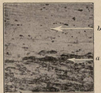
Abb. 37. Aluminium-Gußplatte mit eisenreichen Einschlüssen nach dem Auswalzen. Querschnitt.
