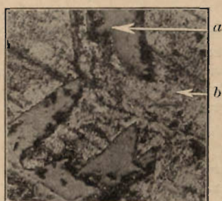
Abb. 8. Aluminium mit 26,6 vH Si. Übereutektisch. a) Si-Kristalle, primär b) Al-Si-Eutektikum. Ungeätzt. 225 \times vergr. (250).
