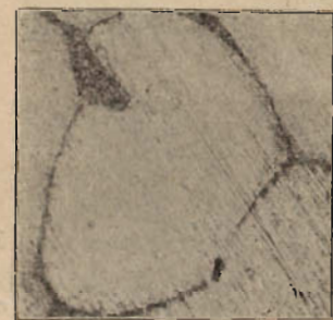
Abb. 12. Aluminium-Walzbarren. Siliziumreiche Stelle. Al-Si-Eutektikum dunkel; Al-Grundmasse hell. Ungeätzt. 225 \times vergr. (250).
