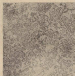
Abb. 22. Aluminium-Walzbarren mit ungleichmäßig verteiltem Eutektikum. Ungeätzt. 40,5 \times vergr. (45).
