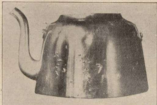
Abb. 1. Aluminiumkessel mit Blasen an der Oberfläche. \frac{1}{3} nat. Größe.
