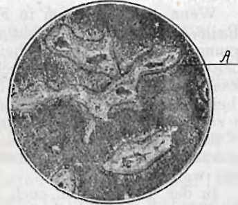
Abb. 6. Lineare Vgr. = 125. Gefüge von gegossenem Aluminium. Endstadium der Schwärzung.
