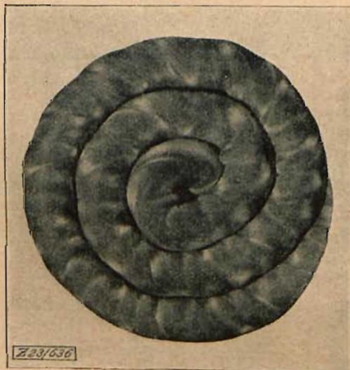
Abb. 17. Verdrehter und darauf spiralartig gebogener Aluminium-Einkristall (geätzt), etwa nat. Gr.
