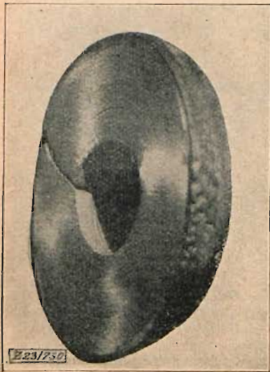
Abb. 14. Ringförmig gebogener Aluminium-Einkristall. Schnitt parallel zur Längsachse des Stabes (geätzt), etwa nat. Gr.
