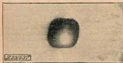
Abb. 3. Vierseitig verzerrter Kugeleindruck auf der Würfeloberfläche eines Kupferkristalls.
